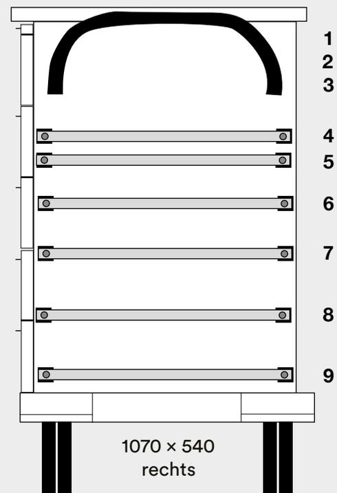
Mögliche Positionen der Seitenschienen an einem 1.070 mm hohen ISO-Wagen
