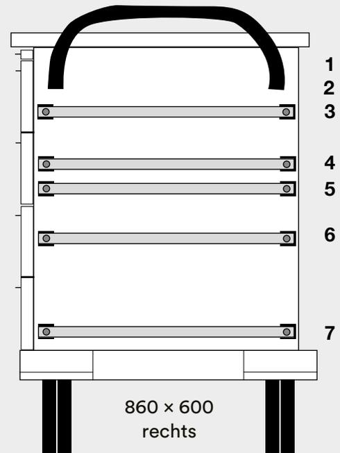
Mögliche Positionen der Seitenschienen an einem 860 mm hohen Funktionswagen
