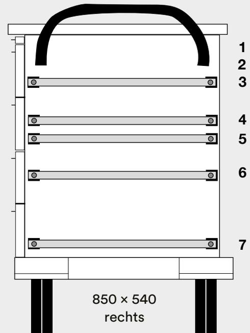
Mögliche Positionen der Seitenschienen an einem 850 mm hohen ISO-Wagen
