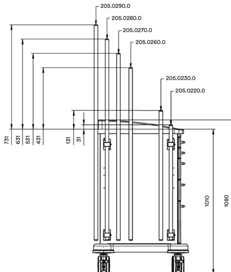
Länge der Basisrohre im Verhältnis zu den Funktionswagenhöhen
