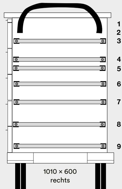
Mögliche Positionen der Seitenschienen an einem 1.010 mm hohen Funktionswagen
